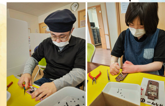
分解前に絶縁テープを取り除いて効率UP。分解後だと鉄板がササクレたり、バリができたりと怪我に繋がるので、先にシールを剥がすのがベスト。
